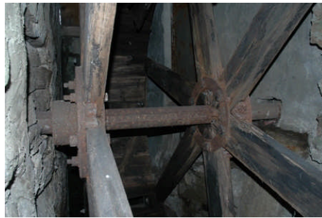
Particolari della ruota motrice ad acqua del mulino di Altanca
